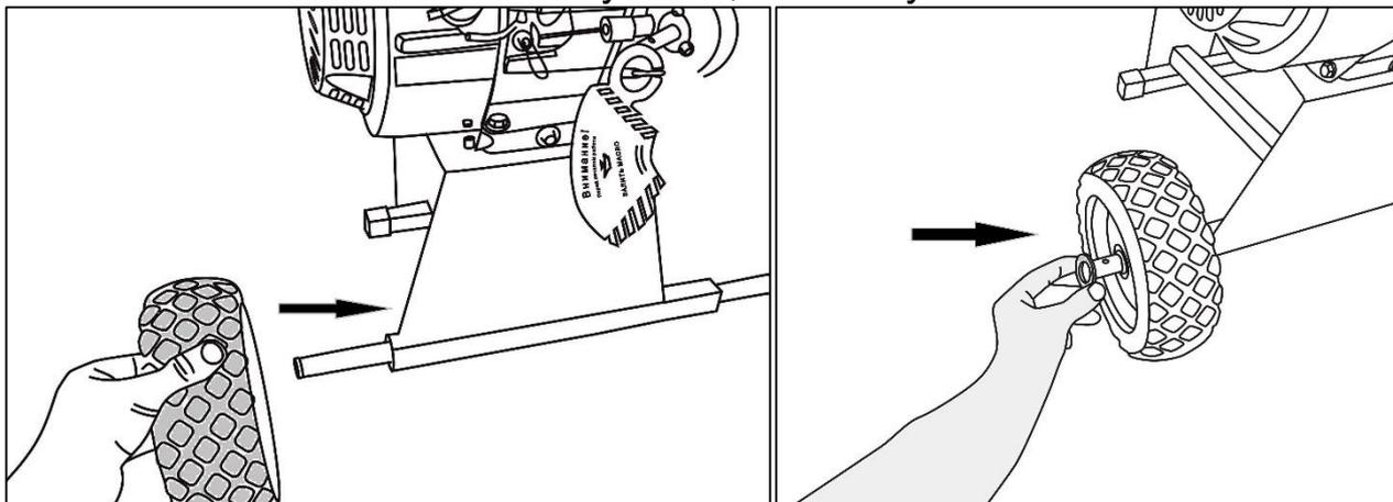
Рис. 3. Установка колес
