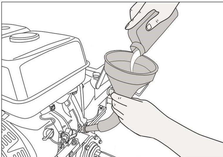
Рис. 11. Доливка масла в двигатель
