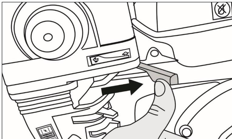
Рис. 17. Установка рычага газа в минимальное положение
