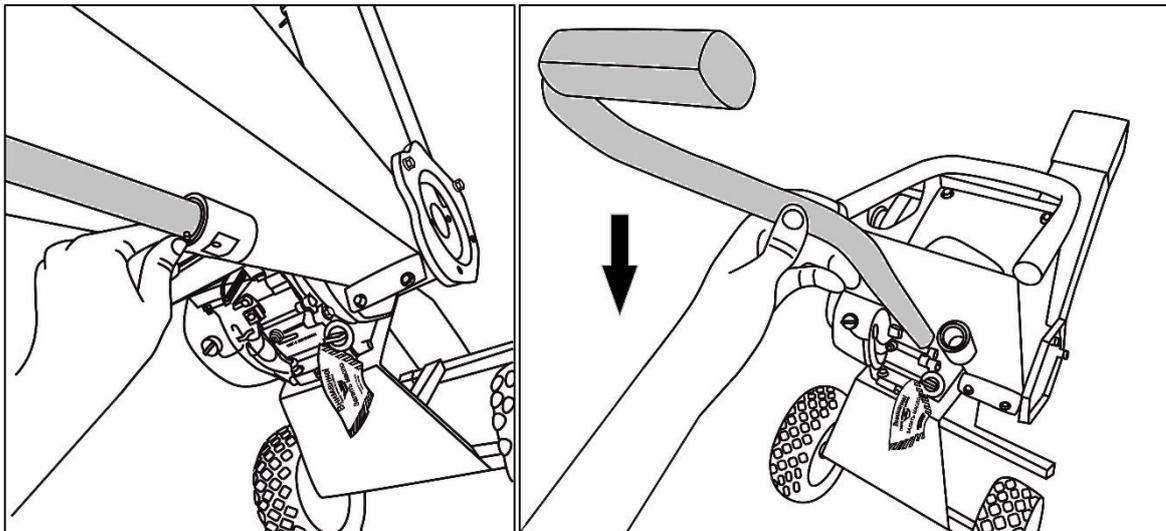
Рис. 9. Регулировка длины рукоятки
