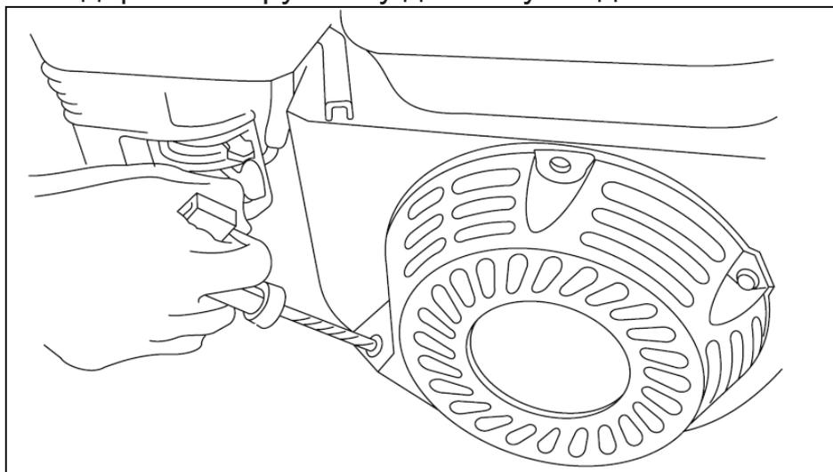
Рис. 18. Запуск двигателя ручкой стартера
